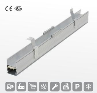
Le profilé type PNR-05532/0 convient pour les applications industrielles générales. Si vous optez pour ce profilé, vous ne devez accrocher aucune gouttière de câbles séparée. Veko équipe de série son profilé d'une gouttière de 55 x 32 mm, d'un câble plat 7 x 2,5 mm², de pattes de suspension, raccords et cloisons de fond. Il est également possible d'intégrer 2 groupes d'éclairage dans un même câble plat, par exemple pour un éclairage de secours.
