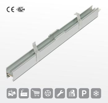
Le profilé type PNR-05532/1 convient pour les applications industrielles générales. Si vous optez pour ce profilé, vous ne devez accrocher aucune gouttière de câbles séparée. Veko équipe de série son profilé d'une gouttière de 55 x 32 mm et d'une cloison de séparation, d'un câble plat 7 x 2,5 mm², de pattes de suspension, raccords et cloisons de fond. Il est également possible d'intégrer 2 groupes d'éclairage dans un même câble plat, par exemple pour un éclairage de secours.
